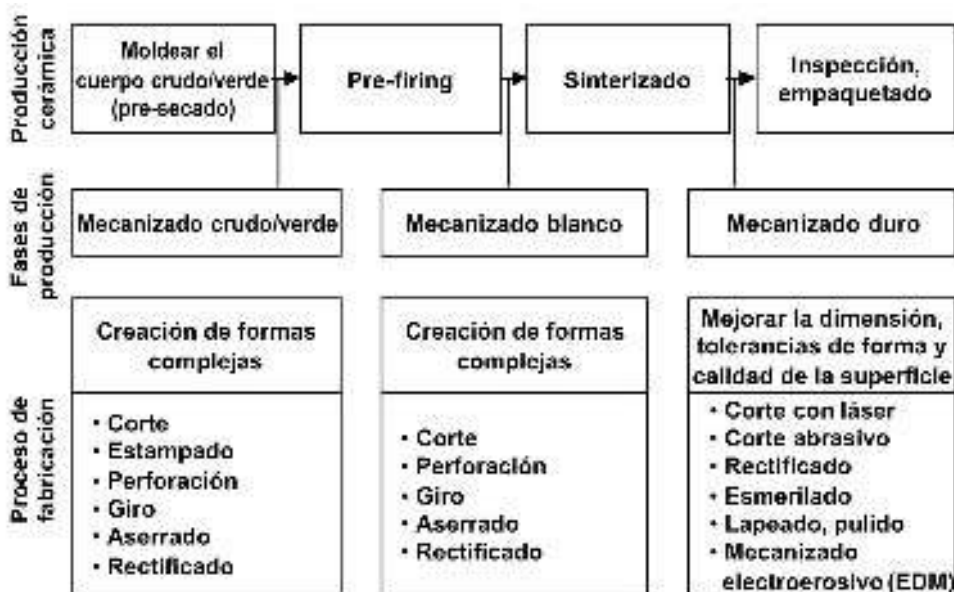
Figura 2.28. Mecanizado verde, blanco y duro en la fabricación de cerámica técnica
