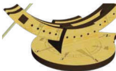
Figura 46. Mecanismo de ajuste de latitude em detalhe.
