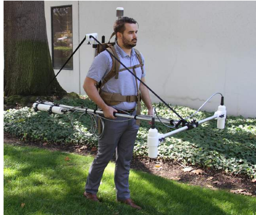
G-864 Magnetómetro de Cesio. Lleva incorporado una tablet Android.
