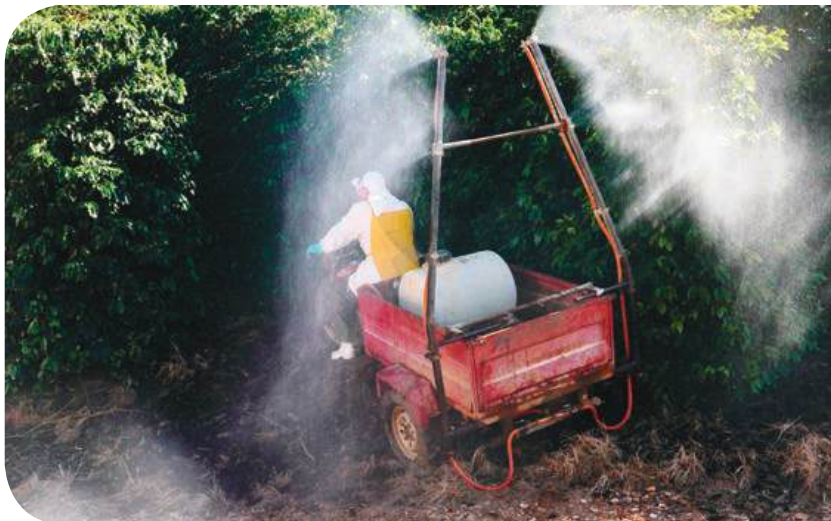
Controle químico mecanizado com triciclo adaptado
