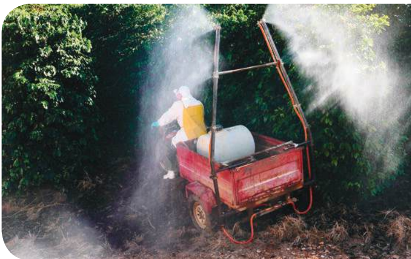
Controle químico mecanizado com triciclo adaptado
