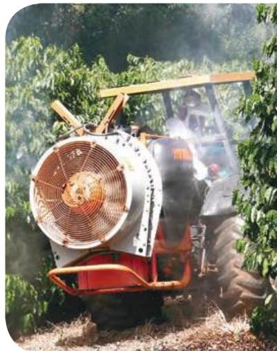
Controle químico mecanizado com pulverizador de 400 ou 2000 litros
