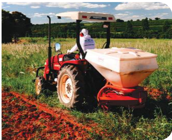
Trator com distribuidor de adubos e calcário
