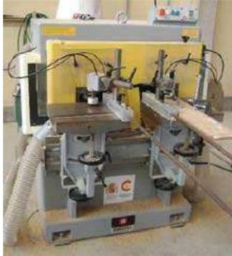
Las medidas de la espiga, se calibran en espesor y ancho variable según el diseño de la pieza, guardando relación con las medidas del escoplo o caja. De esa manera se asegura un ensamble exacto o perfecto, considerando un espacio mínimo para el encolado.
