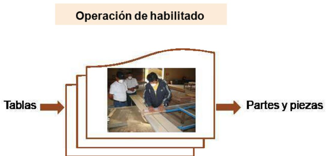
Las medidas se obtienen de manera progresiva al usar la sierra radial, la sierra circular, la garlopa, la reguesadora o cepilladora y la sierra circular con guía de corte transversal. Éste proceso incluye el pegado o encolado de piezas de madera para la fabricación de tableros o piezas de mayor dimensión que por su tamaño no pueden ser obtenidos de una sola pieza únicas de madera.
