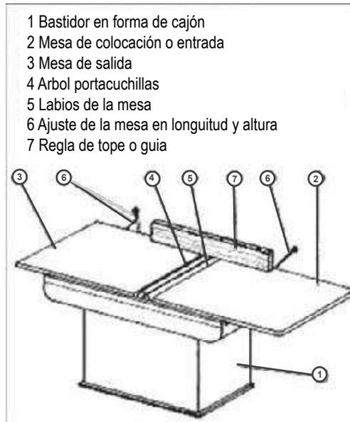
Para la calibración de las cuchillas se utiliza el calibrador, una lámina milimétrica y el dispositivo de graduación. La calibración de las cuchillas requiere de mucha precisión, el punto más alto de las cuchillas debe estar alineado con la mesa de salida.
