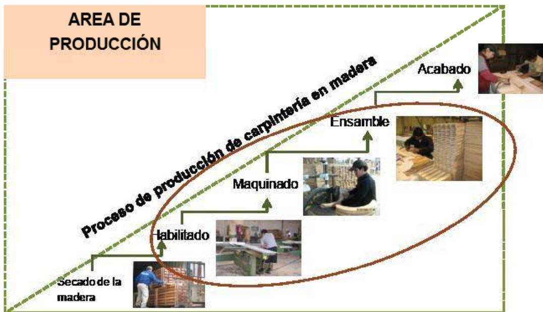
La operación de habilitado se inicia en el predimensionado (trozado) y concluye en el encolado de piezas de madera. El maquinado se inicia con el corte de formas (curvos) y concluye con los cortes de ensamble (juntas y uniones). El proceso de ensamble, comprende el pre armado, lijado y ensamble de partes y piezas, propiamente dicha.
