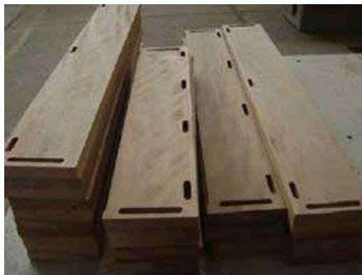
El labrado de la madera lo realiza una broca con movimiento oscilante y horizontal combinado con el movimiento del desplazamiento de las mesas. Se puede graduar la velocidad de avance de acuerdo al tamaño del escoplo, para escoplos más pequeños la velocidad es mayor. La velocidad también dependerá de tamaño de la pieza.
