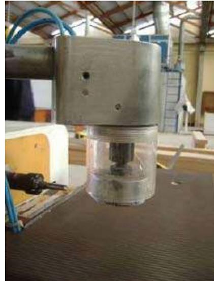
Cuenta con un sistema de sujeción con prisioneros de metal que ejercen una presión de 120 lbs, para mantener fija la pieza, subir y bajar de manera automática.
