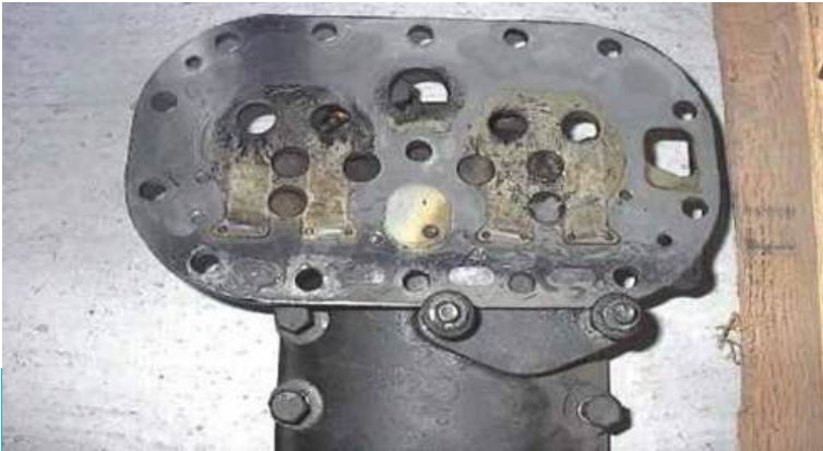
Plato de válvulas con un sobrecalentamiento
