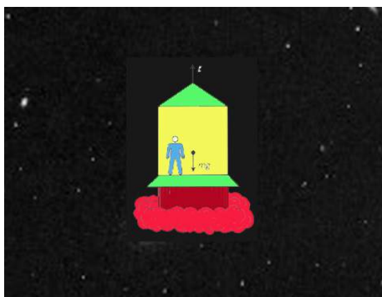
Figura 5.5. Um elevador é colocado num foguete longe da ação de qualquer campo gravitacional. O foguete é acelerado para a frente com aceleração constante g relativamente a um observador de inércia. O observador dentro do elevador larga um corpo inicialmente em repouso e vê esse corpo cair no chão com aceleração g .
