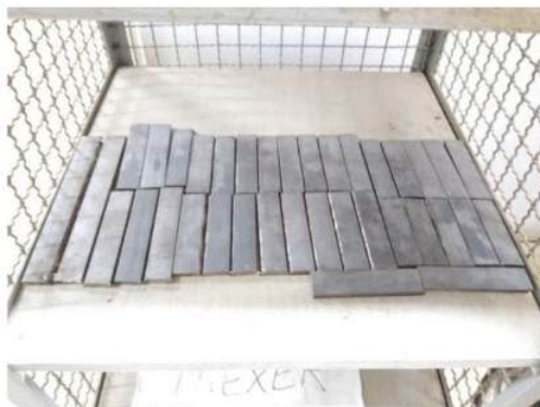
Figura 4 – Chapas de 6 mm para realizar a soldagem
