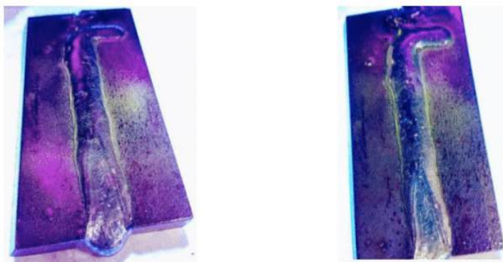
Figura 12 – Ensaio por partícula magnética na chapa 400 A
