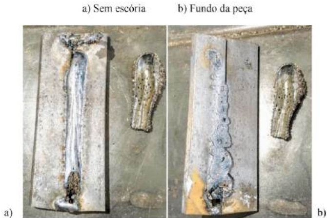
Figura 9 – Soldagem na chapa 600 A –
