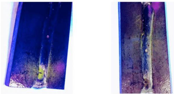
Figura 10 – Ensaio por partícula magnética na chapa 200 A
