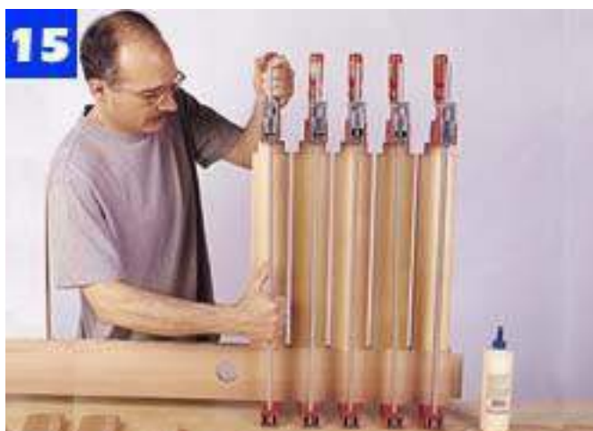
Se realizan múltiples subensamblajes al ensamblar la superficie de la mesa. Primero, las laminas se unen al riel central.
