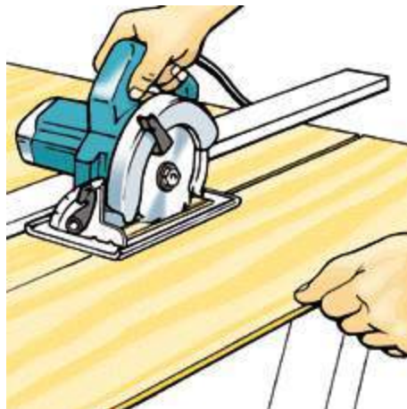
Figura 10 Corte el panel posterior de 1/4 de pulgada de espesor a la medida con una sierra circular. Use una tira recta como guía al hacer los cortes.
