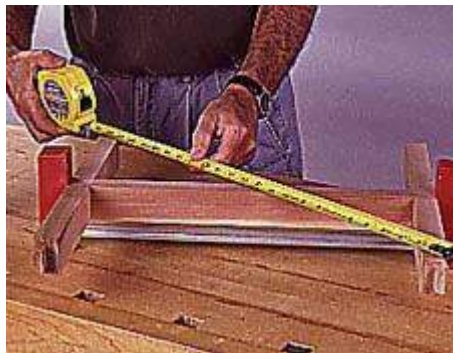
16 Fije un tope a la guía del calibre de ingletes. Utilice una hoja para ranurar para cortar las espigas de los rieles, los bastidores y los listones traseros.
