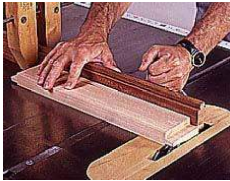
16 Fije un tope a la guía del calibre de ingletes. Utilice una hoja para ranurar para cortar las espigas de los rieles, los bastidores y los listones traseros.
