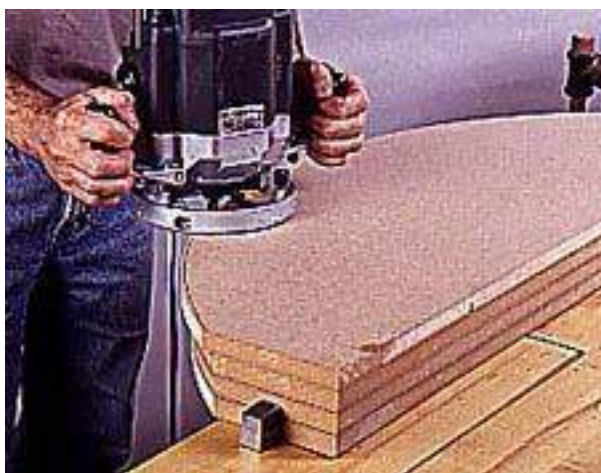
1 Haga la plantilla de forma de plegado con una fresadora de inmersión en un brazo de trasmallo. Corta un arco en una hoja de MDF.
