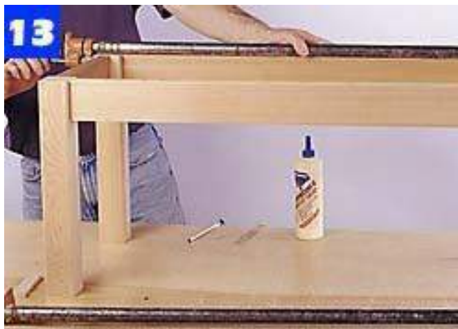
Una dos subensamblajes de delantal para piernas atravesados por un par largo de delantales. Pegue y sujete esto para completar una base de banco.
