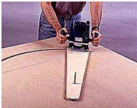
1 Haga la plantilla de forma de plegado con una fresadora de inmersión en un brazo de trasmallo. Corta un arco en una hoja de MDF.
