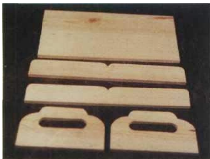
las partes para la bandeja se completa y se presenta antes del montaje.
