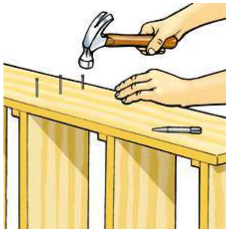
Figura 7 Asegure un lado a los estantes con pegamento y clavos de acabado 6d. Luego voltee el ensamblaje y fije el otro lado. Establecer todas las uñas.
