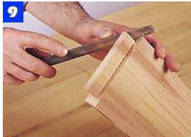
Redondea una espiga con una escofina. El radio de la espiga coincide con el radio dejado por la broca de corte ascendente en espiral utilizada para cortar la mortaja.
