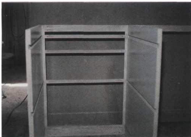
1 Las ranuras espejadas en los mamparos de los cajones están listas para recibir los estantes de los cajones.
