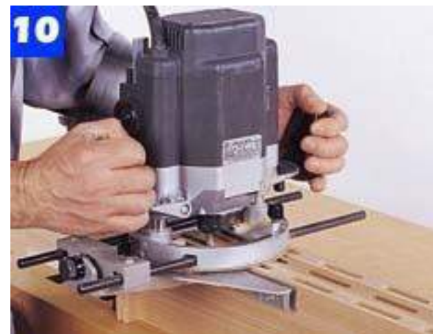
Para cortar la fila larga de mortajas en cada montante y riel, sujete tres de las piezas de trabajo juntas para sostener el enrutador.
