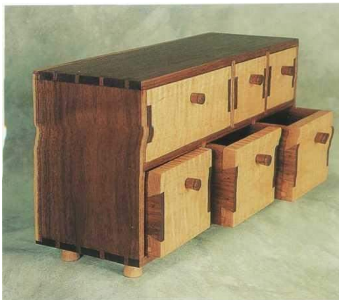
Los cajones parcialmente abiertos revelan las gruesas colas de milano.
