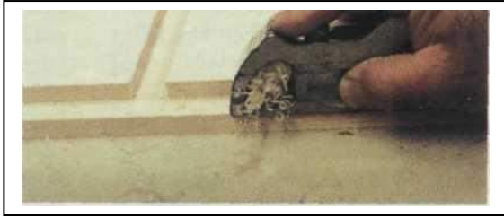
Limpieza de una articulación de conejo con un hombroplano
