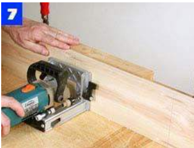
Coloque las juntas de la placa en las piezas del poste y corte las ranuras. Las placas mantienen las piezas alineadas durante el montaje.
