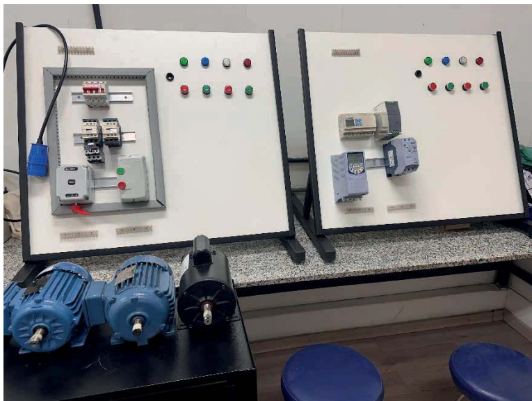
Figura 7 – Bancadas didáticas para automação industrial.
