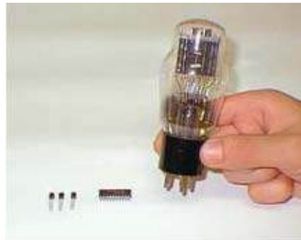
Figura 5 - Transistores, Chip e Válvula.
