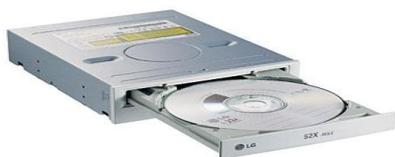
Es la unidad encargada de leer un disco óptico, es decir de lectura mediante un rayo láser, no recargable utilizado para el almacenamiento de información en sistemas informáticos.
