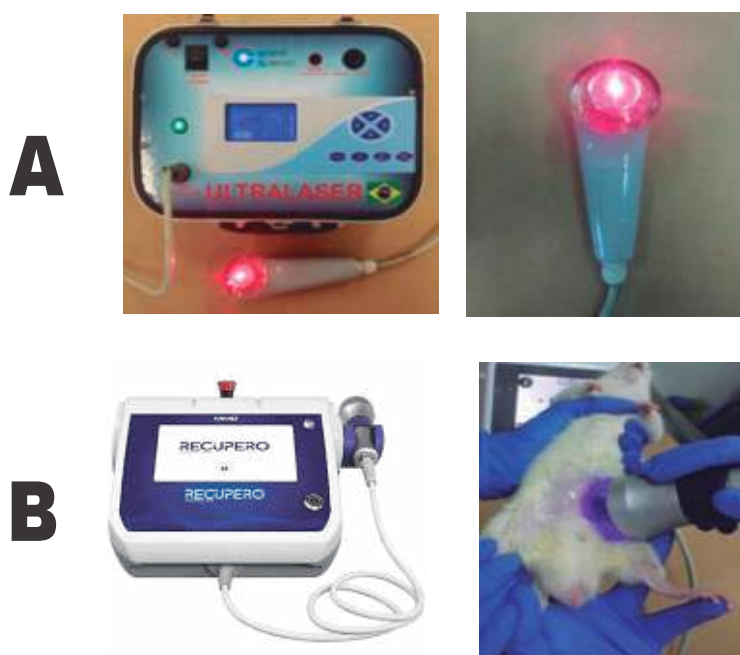
FIGURA 6: Protótipo de ultrassom e laser com dois emissores de luz laser no centro do transdutor de US (A) e Produto com dois lasers no centro do transdutor do US, a luz azul indica o funcionamento do equipamento quando em contato com o tecido biológico (B).
