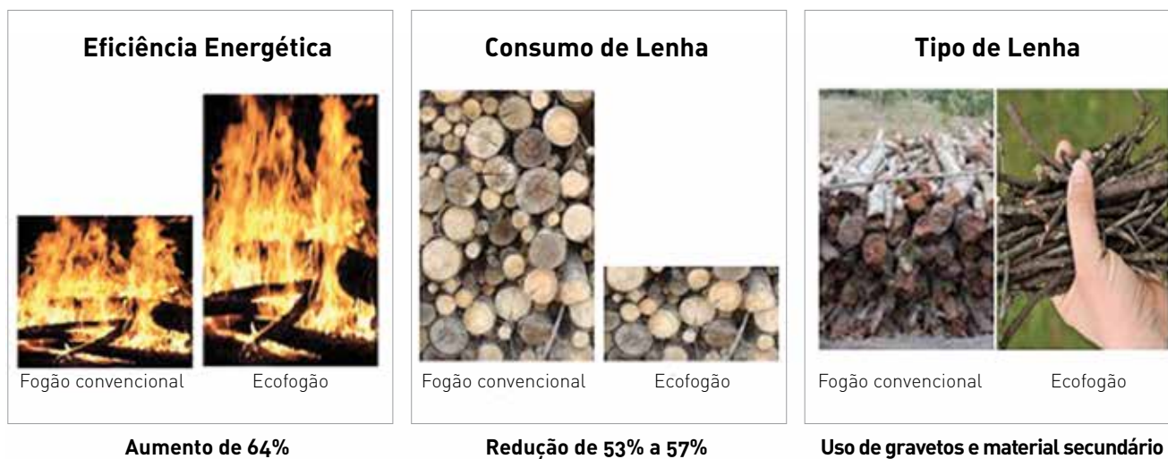
Figura 8 – Resultados de estudo comparativo do ecofogão e fogão a lenha convencional
