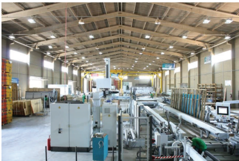
Figura 92: Linha automatizada de produção de painéis wood frame em Araucária (PR)
