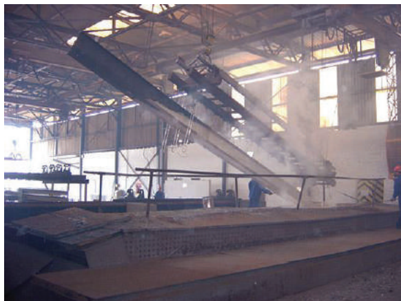
Figura 36: Tanque de imersão da peça de aço para zincagem (Foto: Brafer)
