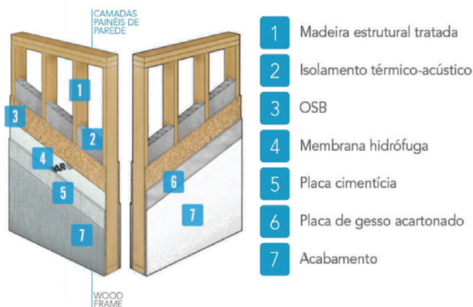
Figura 90: Painel multicamadas no sistema wood frame (Fonte: Tecverde, 2015)
