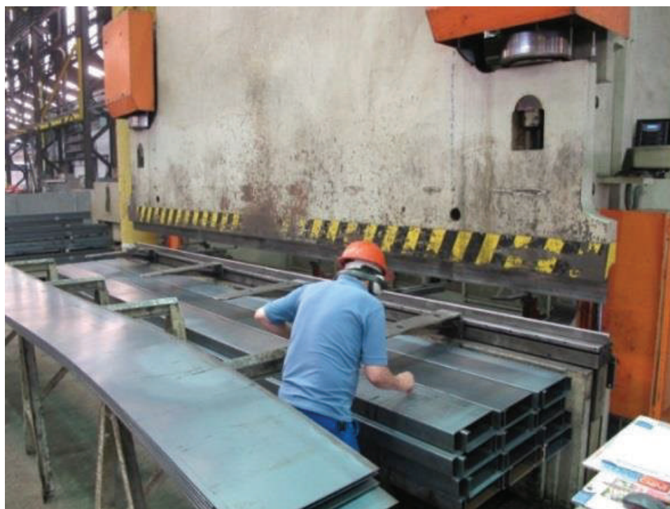
Figura 23: Dobradeira de perfis a frio (Imagem: Sidnei Palatnik)
