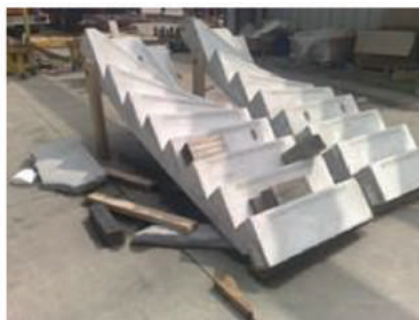
Figura 2: Escada pré-fabricada de concreto (Fonte: ABCIC)
