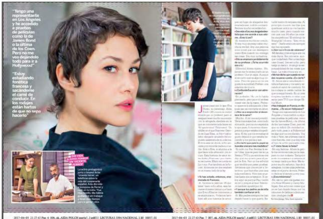
En la imagen, podemos ver un ejemplo de océ de imprenta de la revista Lecturas. En esta prueba de impresión, se puede comprobar que todo está correcto. Si nos fijamos, podemos observar que se incluye la información del documento y las líneas de margen y corte alrededor.
