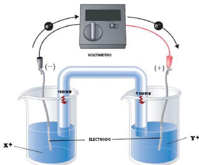
**NOTACIÓN DE UNA CELDA O PILA.** La notación simplificada para describir celdas galvánicas, es la siguiente:
