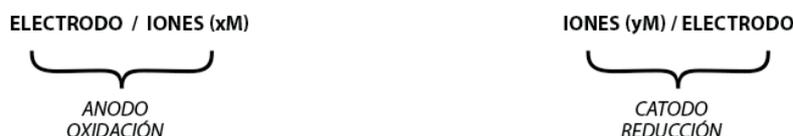
Por convención, el proceso anódico (reacción de oxidación) siempre se pone a la izquierda y el proceso catódico (reacción de reducción) a la derecha. La raya vertical indica una separación entre el electrodo y la solución electrolítica. La doble línea vertical representa la separación de las dos soluciones electrolíticas.
