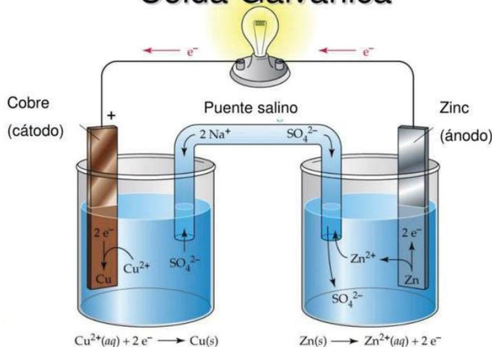
Como se muestra en la figura, la electricidad se transporta a través de una celda electroquímica por tres mecanismos:
