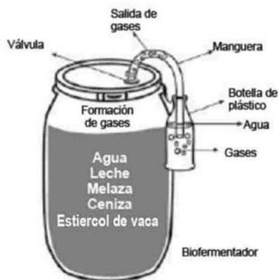
Recipiente con el biopreparado fermentando (observar burbujas de gas en la botella)
