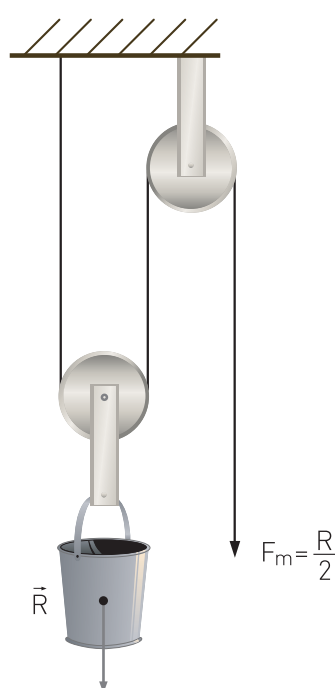
↑ Combinación de polea fija y polea móvil.
