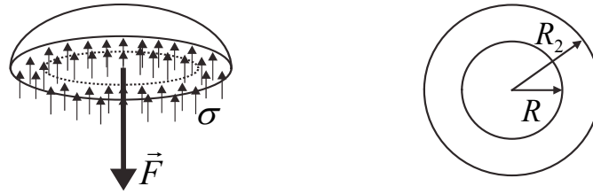
Figura 5.10: Tensão de esmagamento
