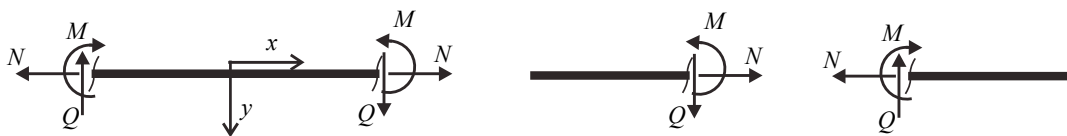
Figura 3.15: Convenção de sinal para os esforços solicitantes
