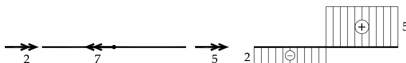
Figura 7.12 – (a) diagrama de corpo livre, (b) diagrama de momento torçor
