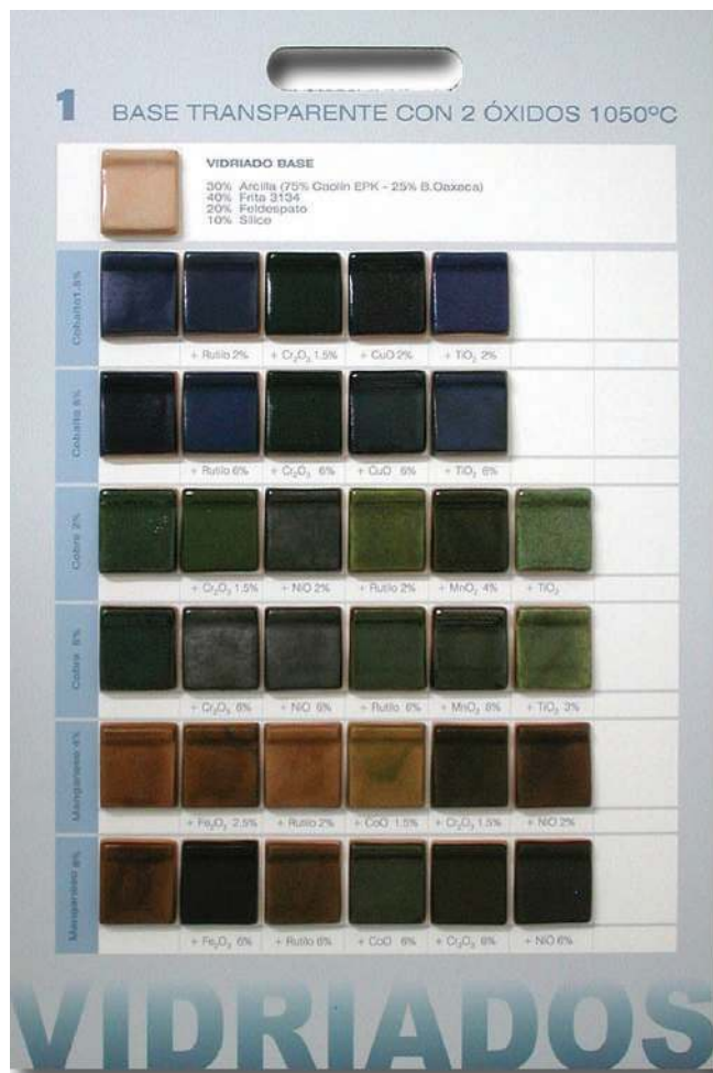
Vidriado base de baja temperatura con adiciones de dos óxidos colorantes
