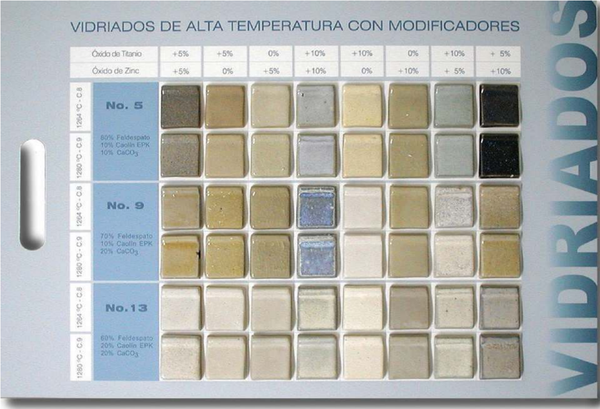
Vidriado base de alta temperatura con adiciones de modificadores (TiO 2 y ZnO)
