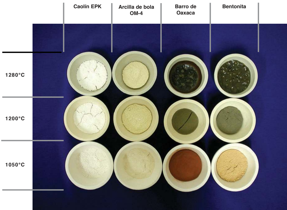
Materias primas arcillosas quemadas a diferentes temperaturas
