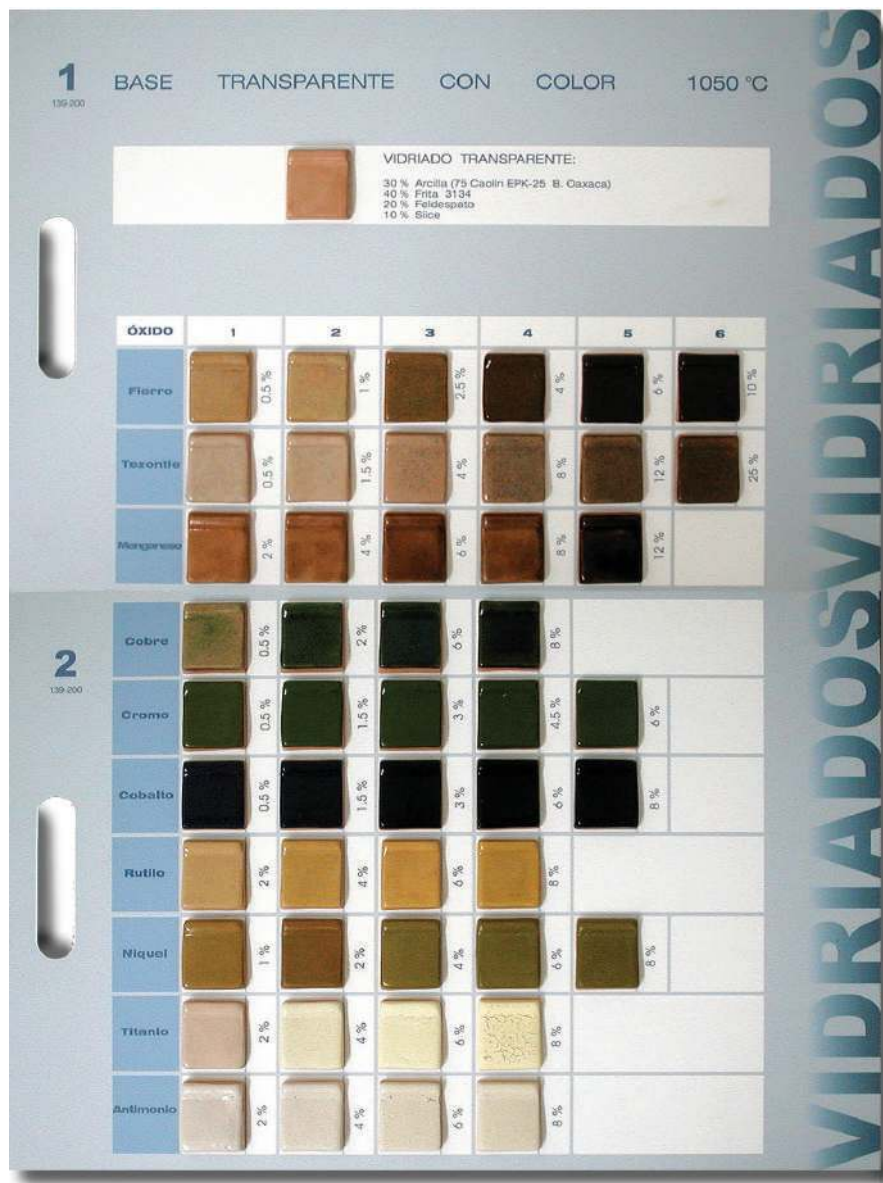
Vidriado base de baja temperatura con adiciones de óxidos colorantes
