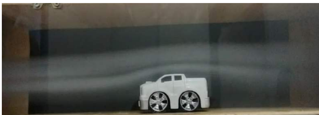
Figura 25 – Visualização de escoamento em um carro de brinquedo.
