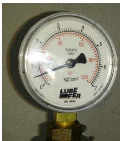
Figura 3 – Manômetro de escala de 0 a 7 kgf/cm² (Próprio autor).
