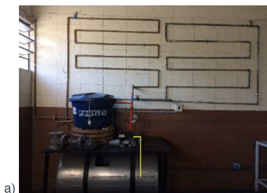
(Figura 5- Bancada Hidráulica 1 "caso a")
