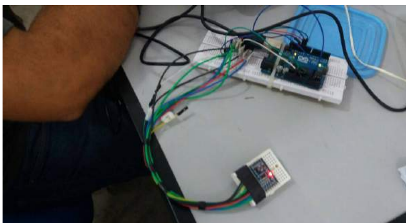
Figura 1. Placa de arduino e acelerômetro usados para a análise de vibrações no motor do carro arrancada
