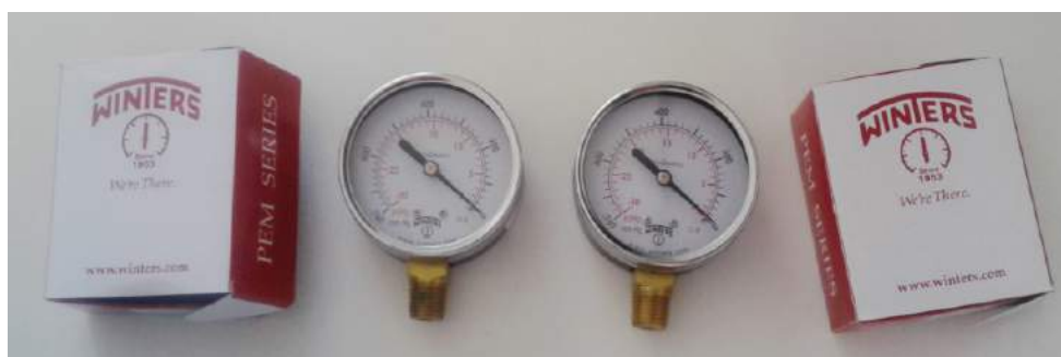
Figura 4 - Vacuômetro de escala de 0 a 760 mmHg (Próprio autor).
