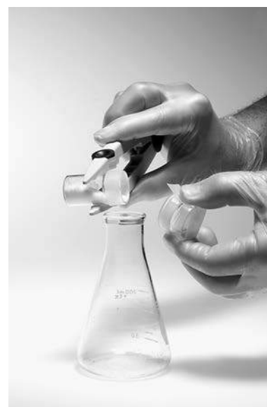
Figure 2-10 Transfert quantitatif d'un échantillon solide. Notez l'utilisation de pinces pour tenir le pèse-filtre et d'une bande de papier pour tenir le couvercle afin d'éviter tout contact entre le verre et la peau.
