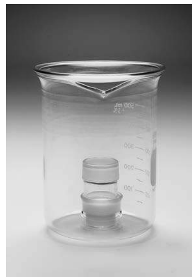
Figure 2-9 Dispositif de séchage des échantillons.
