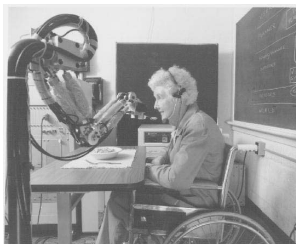
Figura 1. Imagen extraída de “ shogun.vuse.vanderbilt.edu ”, mostrando el denominado “Soft Arm” en acción. El usuario interactúa con dicho sistema a partir de órdenes verbales.
