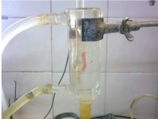
Figura 13: Foto de una cuba de doble camisa donde se monta el preparado
