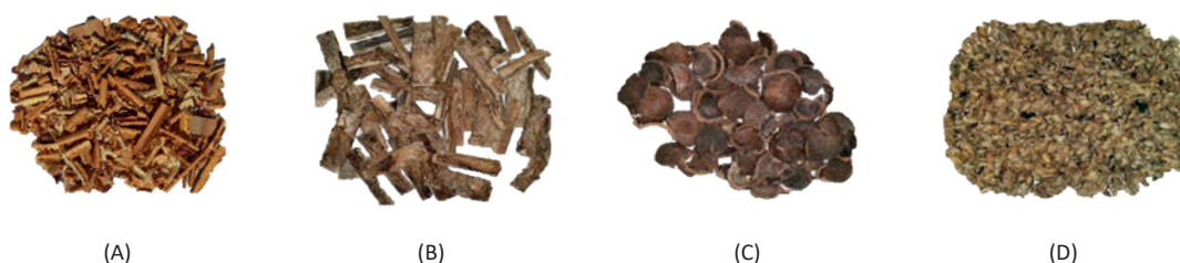
Figura 1. Resíduos lignocelulósicos agroindustriais utilizados. A – serragem de eucalipto, B – fuste de mamoeiro, C – carpelo de noz macadâmia, D – casca de café arábica.
