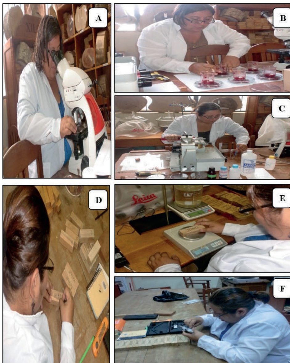
Figura 3. Fase de Laboratorio: A) Observación de las láminas histológicas. B) Tejido macerado de los cinco árboles. C) Micrótomos de deslizamiento horizontal (obtención de muestras). D) Codificación de las probetas de las propiedades físicas. E) Obtención del peso de cada probeta. F) Micrómetro digital (medición de las dimensiones).
