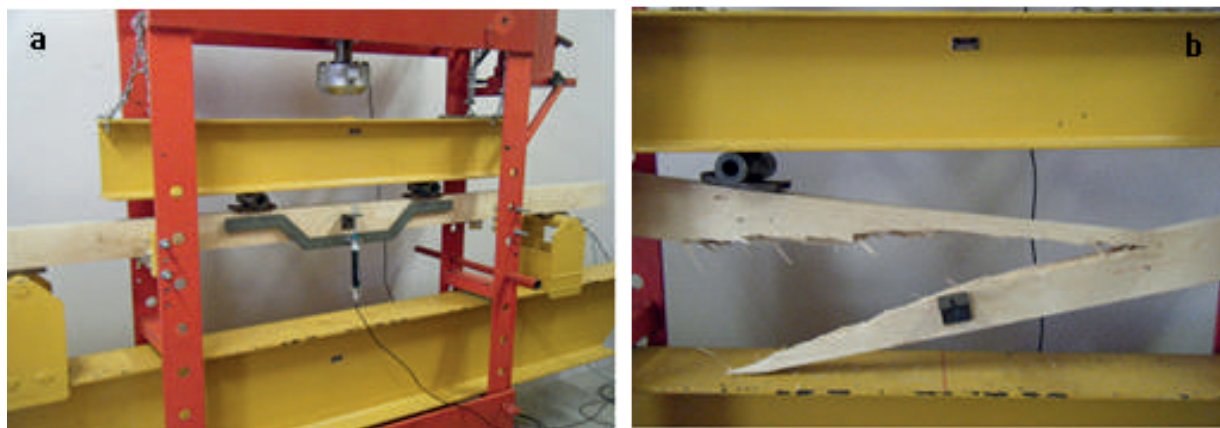
Figura 1. Ensaio de flexão estática em relação ao eixo de maior inércia – edgewise . a) Pórtico de ensaio; b) Viga ensaiada.
