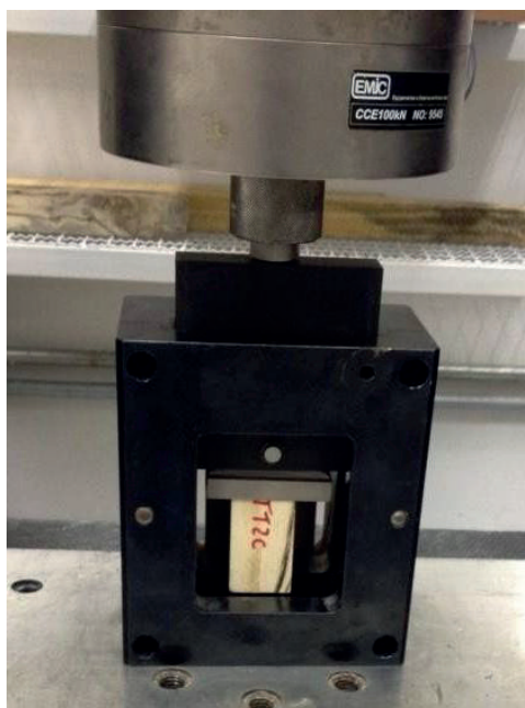
Figura 5. Ensaio de cisalhamento de um corpo de prova na máquina universal de ensaios.
