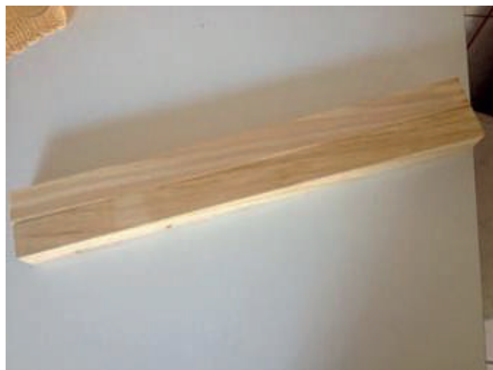
Figura 3. Sarrafos colados lateralmente com adesivo à base de Poliacetato de Vinila.
