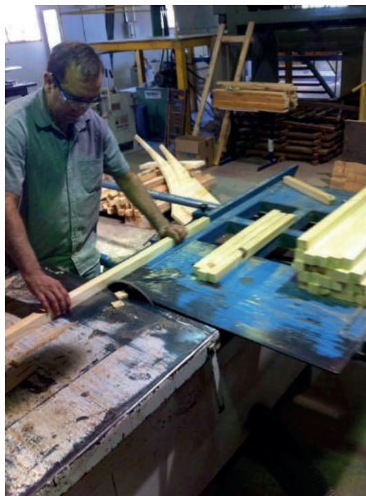
Figura 1. Corte das peças em sarrafos com auxílio de uma Serra Circular.
