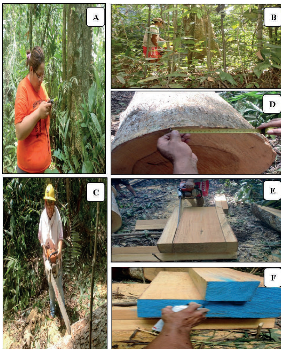
Figura 2. Fase de Campo: A) Georeferenciación de los árboles de Ormosia paraensis . B) Tumbado de los árboles. C) Obtención de las trozas. D) Medición para la obtención del tablón central. E) Obtención de las viguetas. F) Pintando los extremos de las viguetas de O. paraensis .
