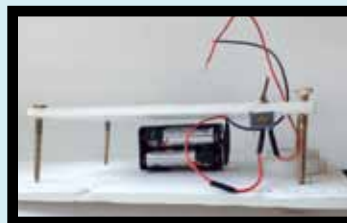
Interruptor en serie con la batería.
