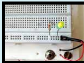
Interruptor en serie con la batería.
