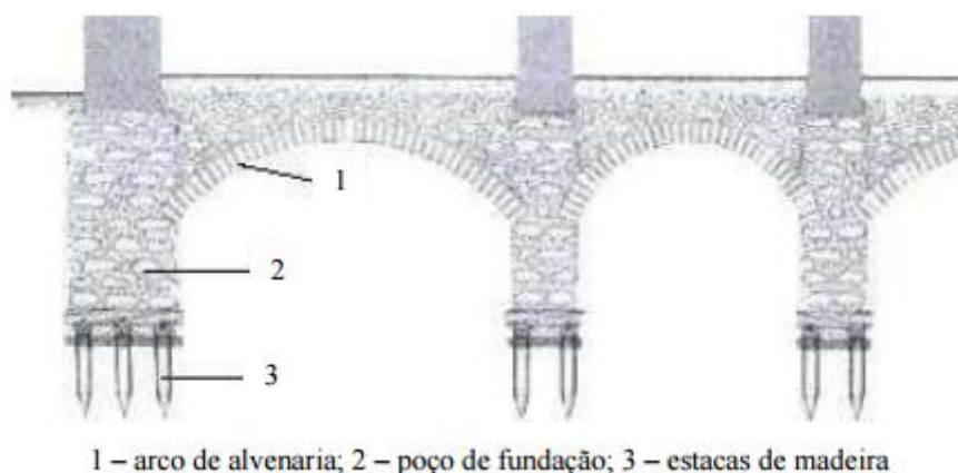
Figura 4- Representação esquemática das fundações indiretas características dos edifícios pombalinos (Ramos, 2014)
