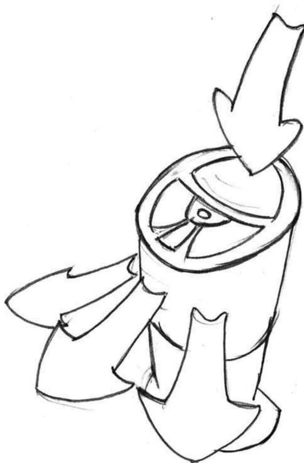
Diagrama que muestra el flujo del aire al pasar por un calefactor
