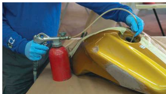
Aplicación interior de imprimación anticorrosiva.
