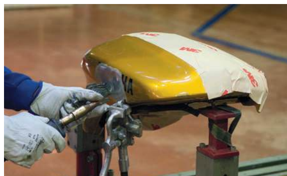
Soldadura de arandelas en la zona deformada.
