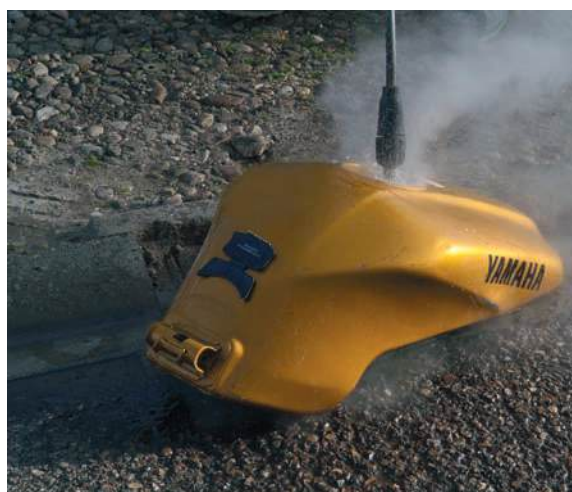
Proceso de desgasificado.
