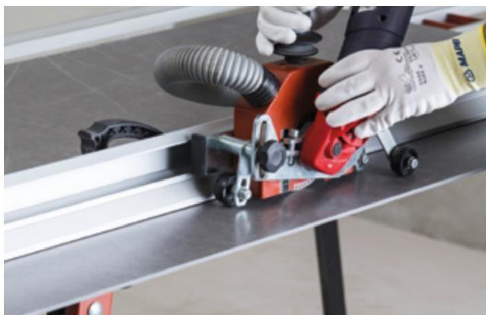
Прямолинейная резка с помощью УШМ
