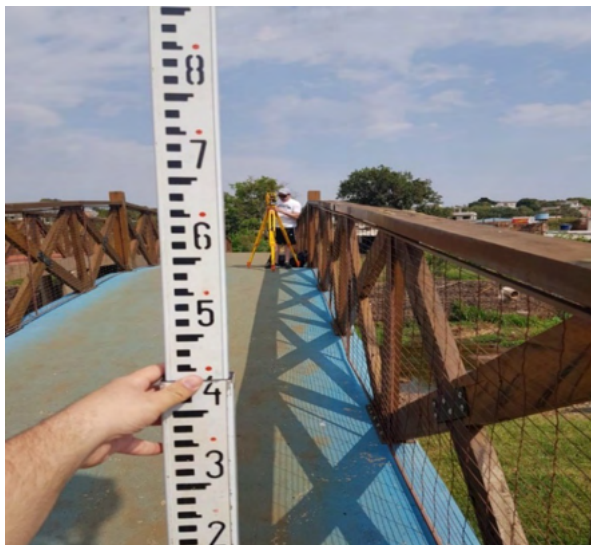
Figura 9: Medição in loco das rampas no Ecopark.
