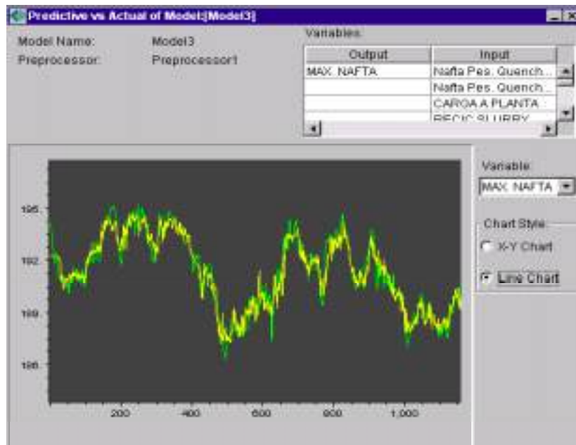
Figura 3: predicción del punto final para la nafta de la FCCU (línea amarilla) vs. el actual (línea verde) durante el período de validación.
