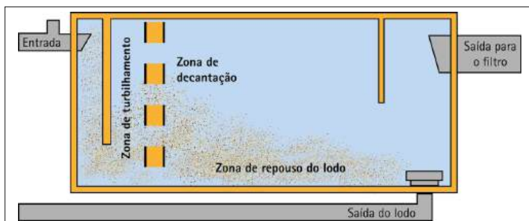
Figura 6.3 Representação esquemática de um decantador horizontal usado em estações de tratamento de água.
