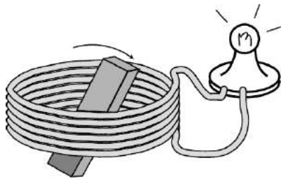
f / A generator.
