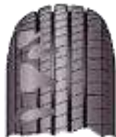
Desgaste irregular (Varios problemas)
