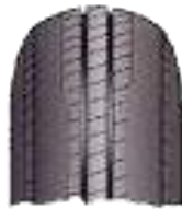
Presión de aire Deficiente
