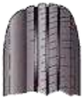
Desgaste por caída
