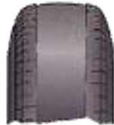
Presión de Aire excesiva
