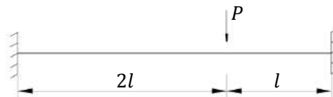
Figura 3.14. Viga biempotrada con carga puntual.
