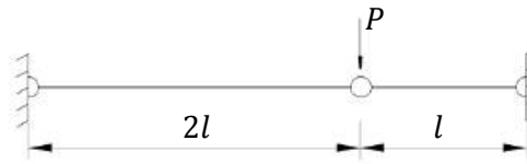
Figura 3.15. Mecanismo de colapso propuesto.
