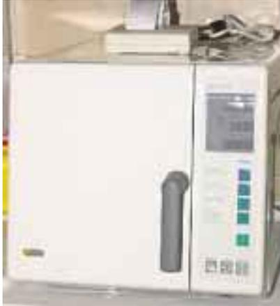
Imagen de un autoclave de vapor. Sobre él puede observarse una impresora.
