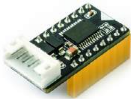
Módulo controlador de motores (cuatro)
