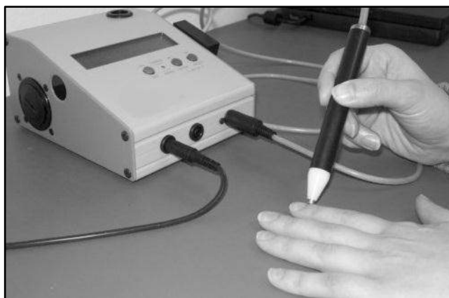
Figura 2 – Aparelho de medição da resistência elétrica da pele em pontos de acupuntura
