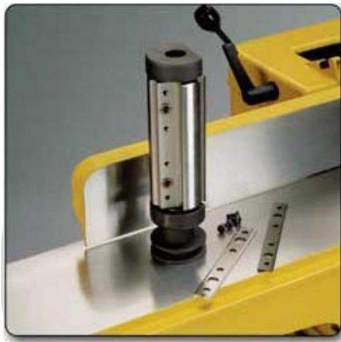
Las cuchillas recambiables reducen los costos de operación ya que no necesitan mantenimiento y se cambian en unos minutos. Los mecanismos electrónicos para determinar el grueso del cepillado simplifican el manejo de la máquina y la dotan de mayor precisión.
