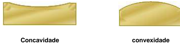
Figura 8 – Concavidade e Convexidade como Desvios de Planeza
