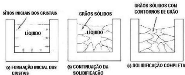
Figura 6 - Processo de solidificação dos metais
