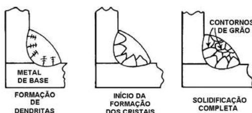
Figura 8 - Processo de solidificação de uma junta soldada
