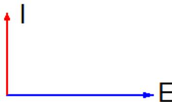
Uma carga puramente capacitiva não realiza trabalho, ou seja, durante meio ciclo da tensão da fonte, o capacitor armazena energia sob a forma de campo elétrico e durante o segundo meio ciclo da tensão ele devolve a energia para a fonte, o que pode ser mais bem compreendido ao se observar à figura abaixo.
