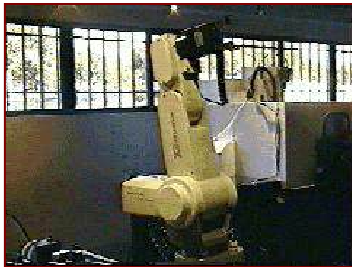
Figura 1. El robot Mitsubishi es de tipo brazo articulado y tiene 5 articulaciones. El principal uso de este robot es para ensamble y carga/descarga de piezas a la estación de medición.
