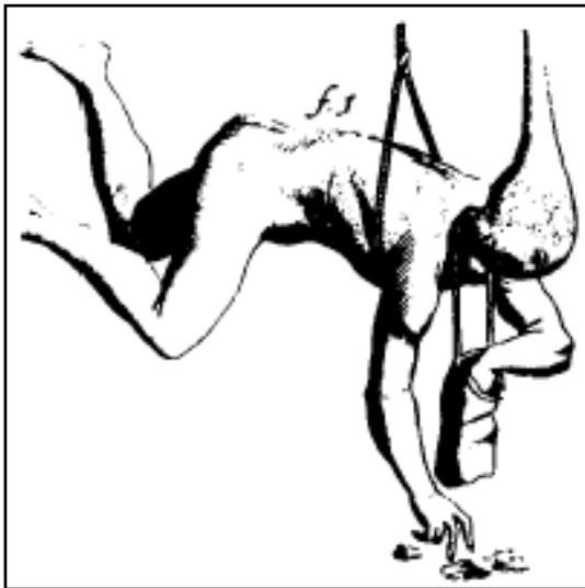
Figura 1-1. Primeros Dispositivos de Respiración Imprácticos. Este diseño de 1511 muestra la cabeza del buzo cubierta por una bolsa de piel con un tubo de respiración extendido hasta la superficie.
