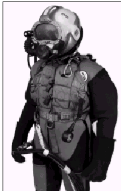
Figura 15-2. MK 21 MOD 0 con Traje de Agua Caliente, Calentador de Gas y Cilindro de Gas de Emergencia
