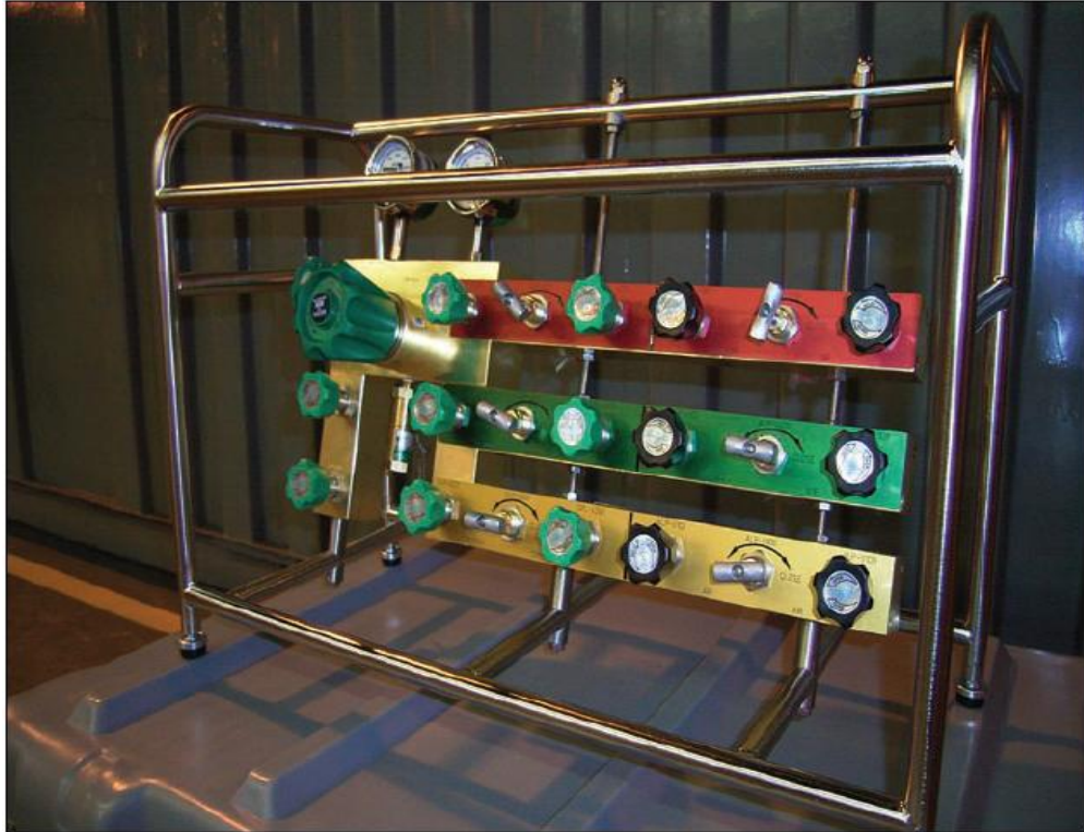
Figura 8-9. Ensamble de Control de Regulación de Oxígeno (ORCA) II.
