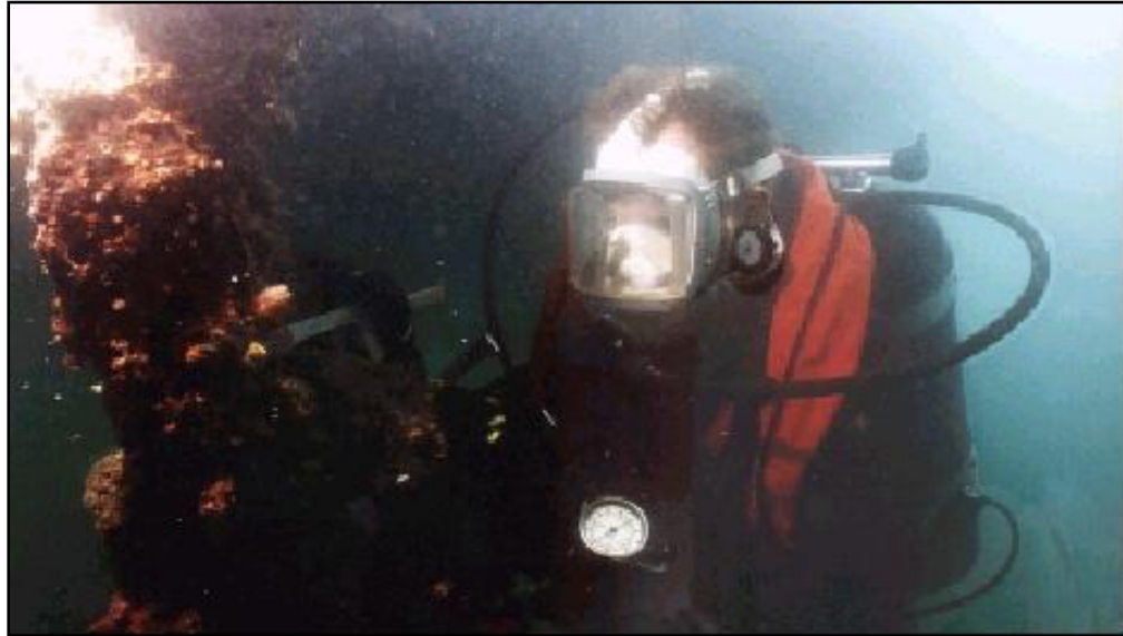
Figura 7-2. Máscara Facial Completa (MFC).
