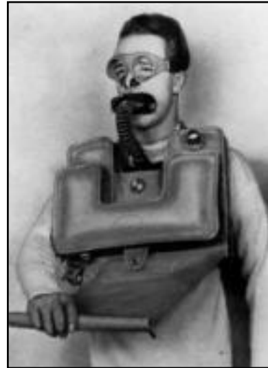
Figura 1-10. Aparato Original de Escape Sumergido Davis
