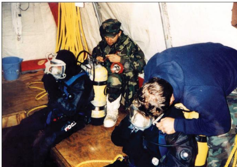
Figura 11-1. Buceo en Hielo con SCUBA. Los buzos con trajes secos Typhoon y SCUBA Aga/Divator FFM con reguladores aprobados para agua fría.
