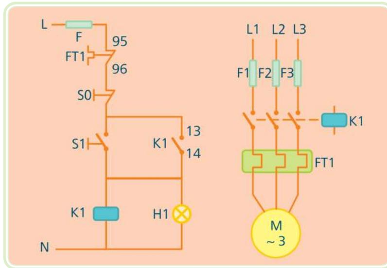
**Figura 3.7: Diagramas de comando e de força de uma partida direta**
