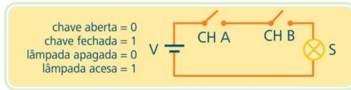
**Figura 4.2: Circuito elétrico equivalente da porta AND**
