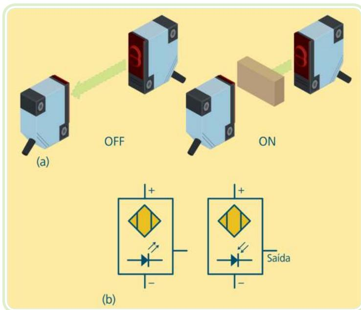
**Figura 2.7: Sensor óptico de barreira direta: funcionamento (a) e simbologia (b)**
