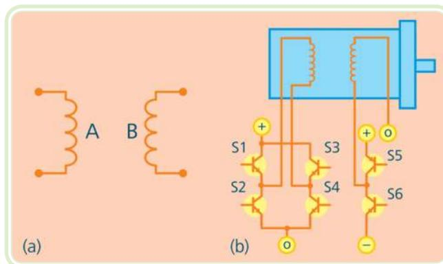
**Figura 3.15: Motores bipolares: enrolamentos (a) e exemplo de acionamento (b)**
