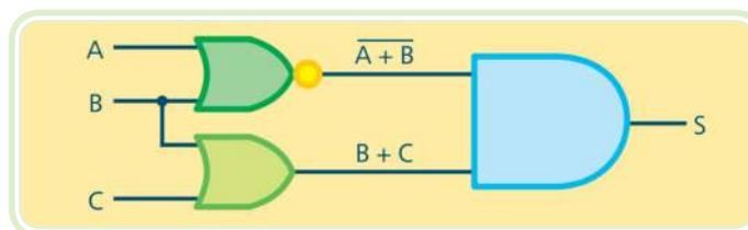
**Figura 4.17: Circuito lógico com as expressões lógicas de saída**
