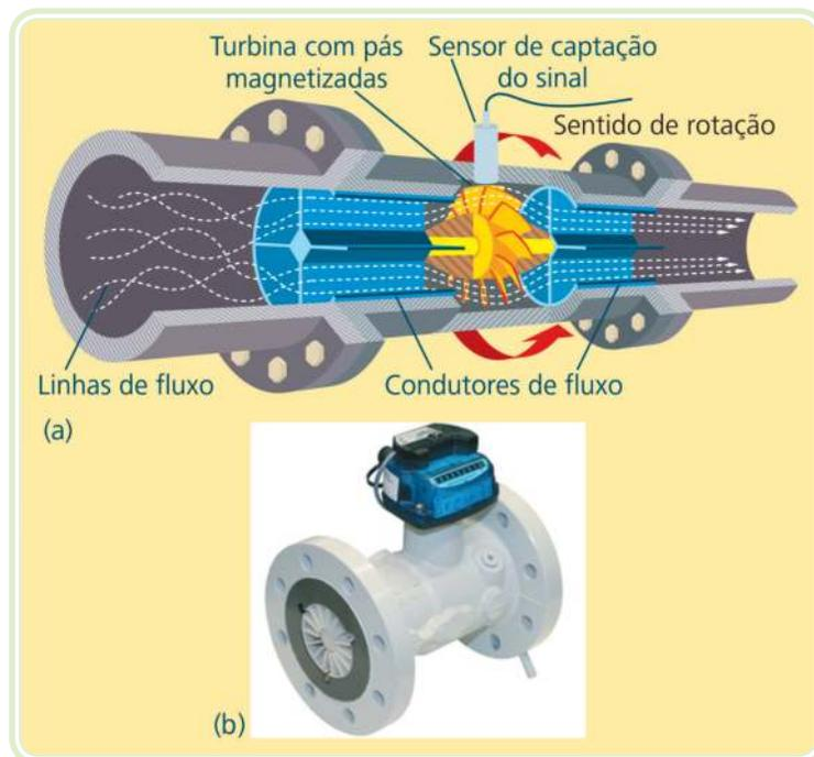
**Figura 2.18: Sensor de vazão tipo turbina: funcionamento (a) e exemplo de transmissor de vazão tipo turbina (b)**
