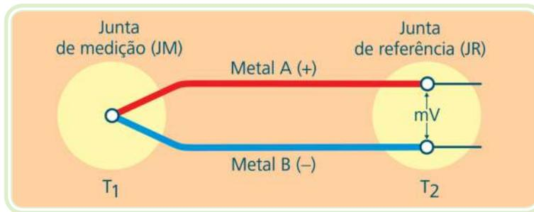
**Figura 2.13: Princípio de funcionamento de um termopar**
