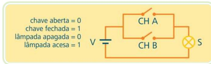
**Figura 4.5:** Circuito elétrico equivalente da porta *OR*
