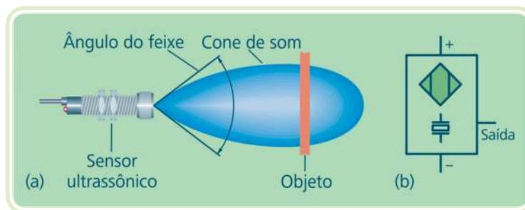
**Figura 2.8: Sensor ultrassônico: área de detecção (a) e simbologia (b)**
