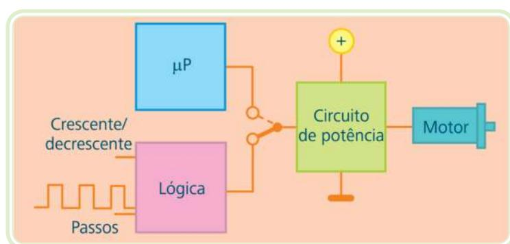
**Figura 3.13: Diagrama de blocos do circuito de acionamento de um motor de passo**
