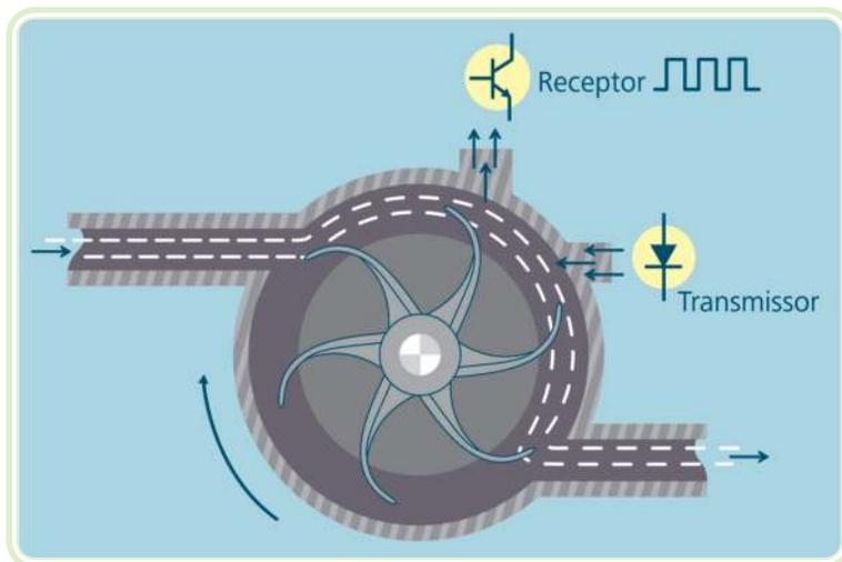
**Figura 2.19: Princípio de funcionamento do sensor óptico de vazão**
