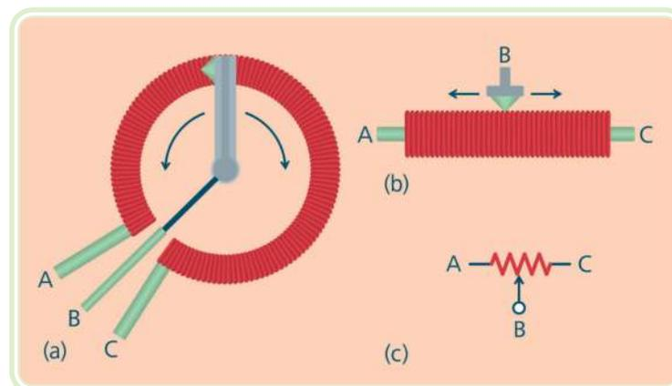
**Figura 2.9: Sensor potenciométrico: rotacional (a), linear (b) e simbologia (c)**
