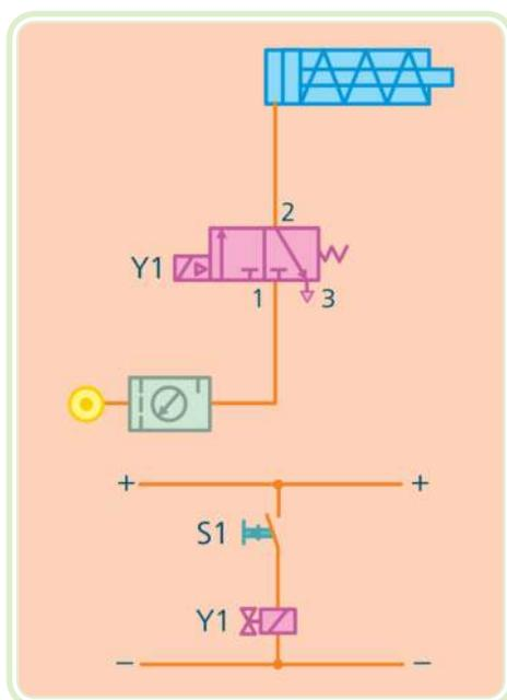
**Figura 3.18: Circuito eletropneumático**
