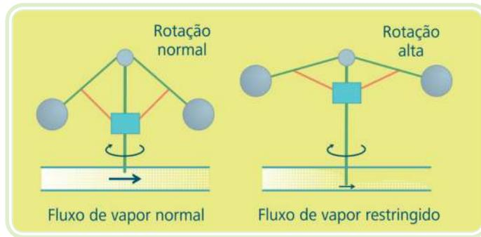
**Figura 1.2: Mecanismo de regulagem do fluxo de vapor**
