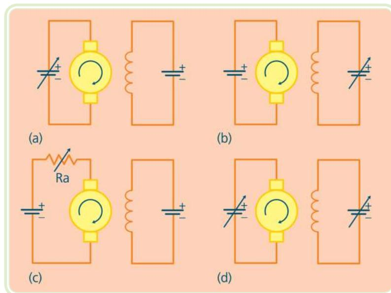
**Figura 3.10: Acionamento do motor CC: controle pela armadura (a), controle pelo campo (b), controle pela resistência na armadura (c) e controle pelo campo e armadura (d)**
