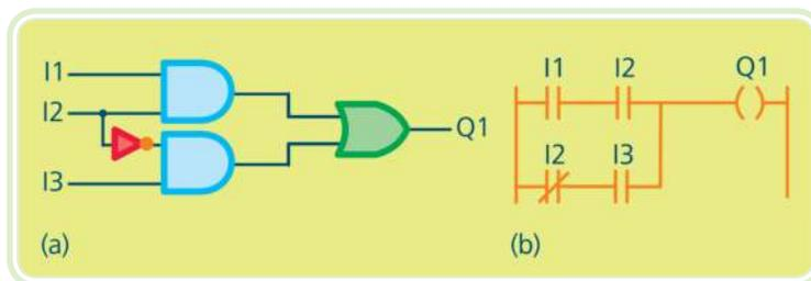
**Figura 5.11: Exemplo de função lógica: circuito digital (a) e diagrama ladder (b)**
