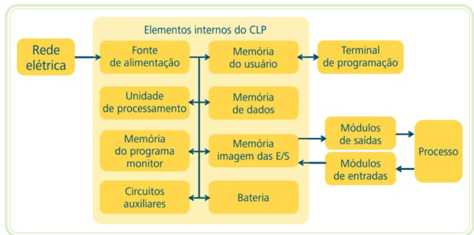
**Figura 5.4: Estrutura interna de um CLP**
