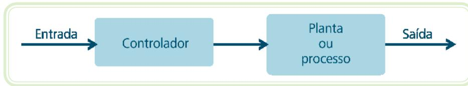
**Figura 3.19: Diagrama de blocos do sistema em malha aberta**
