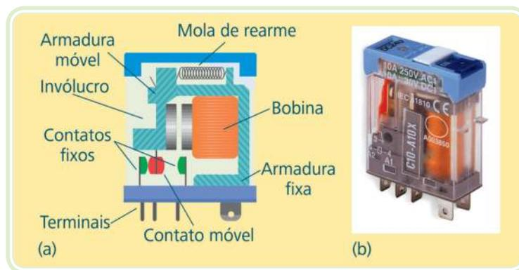
**Figura 3.1: Relé: estrutura simplificada (a) e dispositivo comercial (b)**
