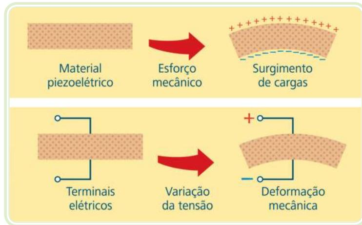
**Figura 2.11: Princípio do sensor piezoelétrico**
