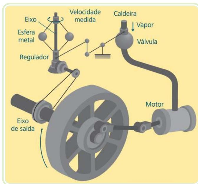
**Figura 1.1: Regulador de fluxo de vapor de Watt**
