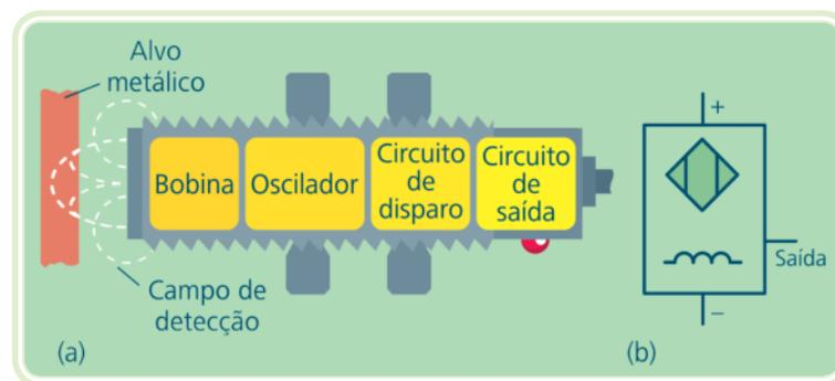
Figura 2.1: Sensor indutivo: diagrama do sensor (a) e simbologia (b)
