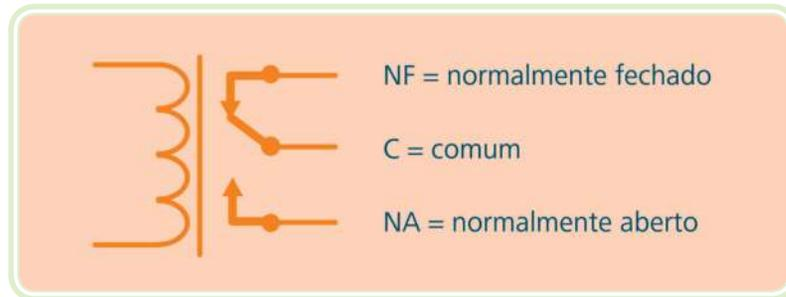
**Figura 3.4: Contatos NF, C e NA com o relé desenergizado**
