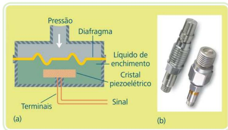
**Figura 2.12: Esquema básico do sensor piezoelétrico (a) e foto de um sensor de pressão piezoelétrico (b)**
