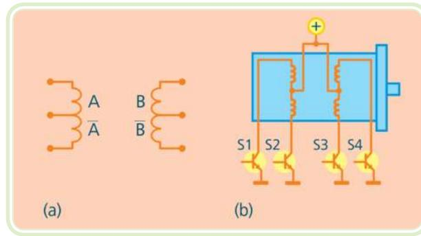
**Figura 3.14: Motores unipolares: enrolamentos (a) e exemplo de acionamento (b)**
