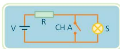
**Figura 4.8: Circuito elétrico equivalente da porta NOT**
