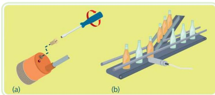
**Figura 2.3: Sensor de proximidade capacitivo: parafuso para ajuste de sensibilidade (a) e utilização para detecção de líquido dentro de garrafas (b)**
