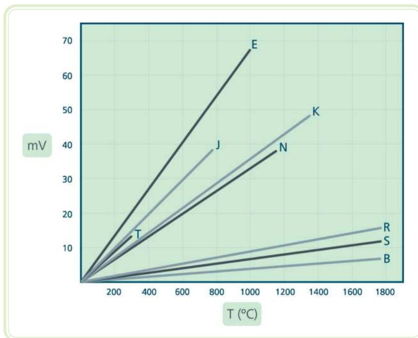
**Figura 2.14: Correlação entre tensão gerada e temperatura de diversos termopares com a junta de referência a  $0^\circ\text{C}$**
