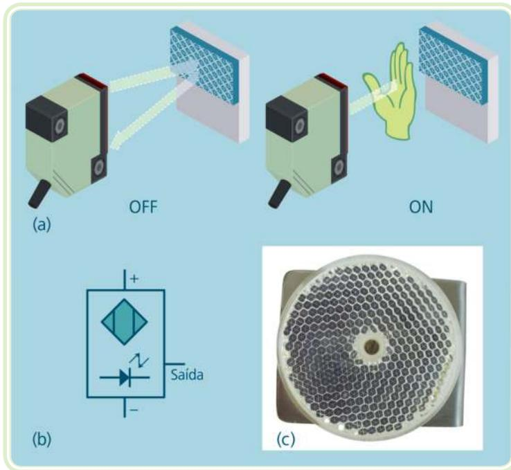
**Figura 2.6: Sensor óptico por retroreflexão: funcionamento (a), simbologia (b) e exemplo de espelho prismático (c)**
