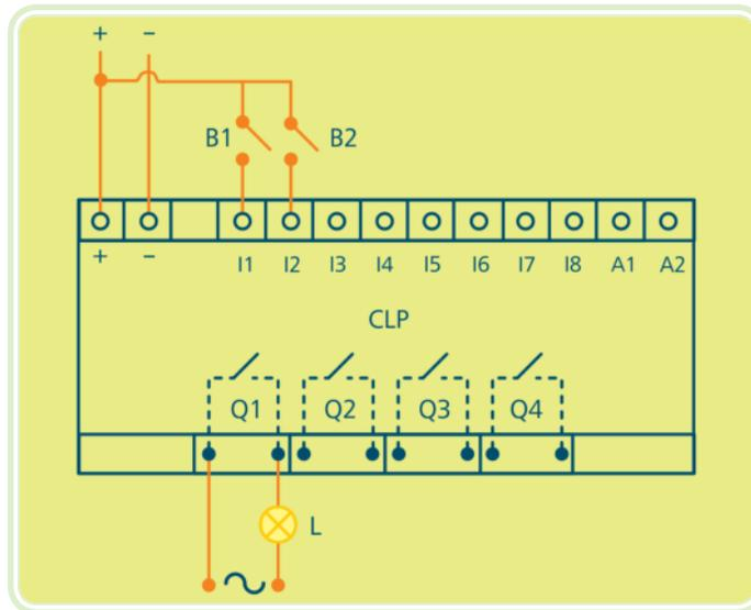
**Figura 5.10: Exemplo de implementação da função lógica E em CLP**
