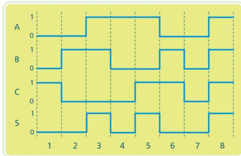
**Figura 4.19: Diagrama temporal do circuito lógico**
