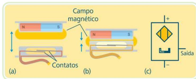
**Figura 2.4: Sensor magnético: contatos abertos (a), contatos fechados (b) e simbologia (c)**
