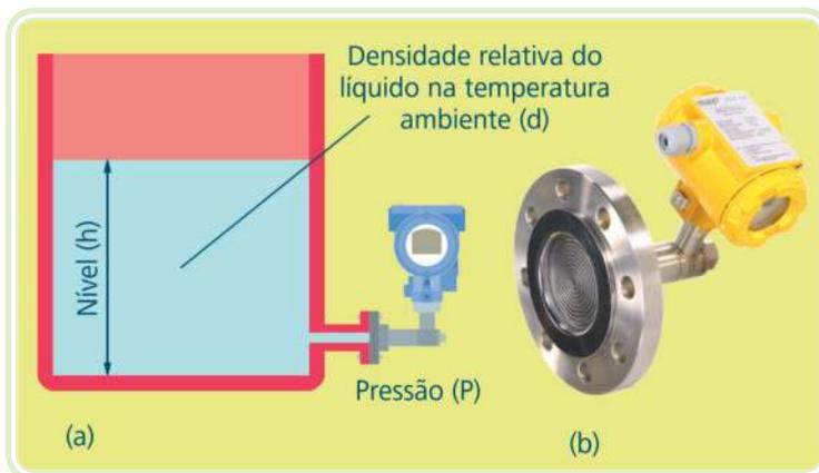
**Figura 2.17: Medição de nível com tanque aberto (a) e exemplo de transmissor de nível (b)**
