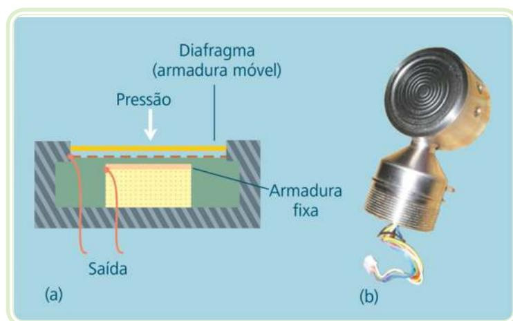
**Figura 2.10: Sensor de pressão capacitivo: detalhes construtivos (a) e detalhe do diafragma do sensor (b)**
