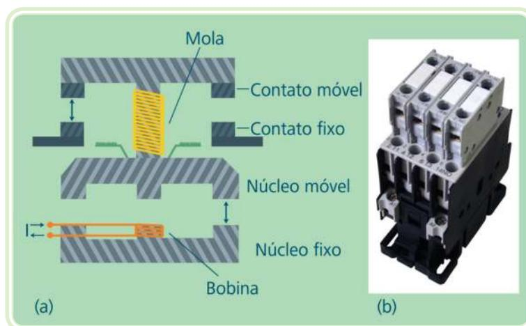
**Figura 3.5: Contator: estrutura simplificada (a) e dispositivo comercial (b)**
