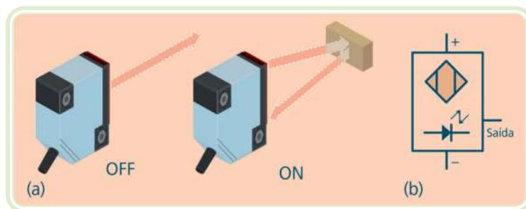
**Figura 2.5: Sensor óptico por reflexão difusa: funcionamento (a) e simbologia (b)**
