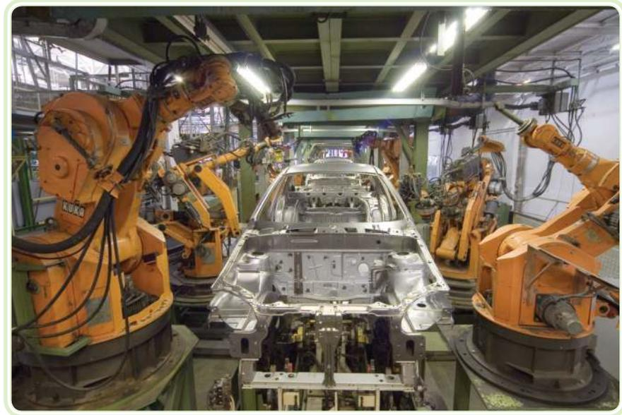
**Figura 1.3: Robôs usados na indústria automobilística**
