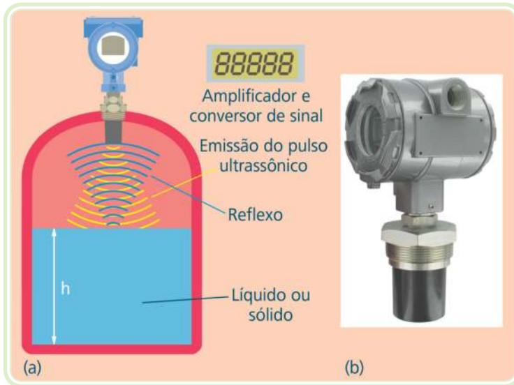
**Figura 2.16: Sistema de medida com ultrassom: funcionamento (a) e transmissor de nível por ultrassom (b)**
