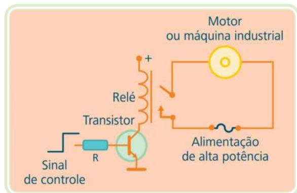
**Figura 3.3: Relé usado para acionar carga de alta potência**
