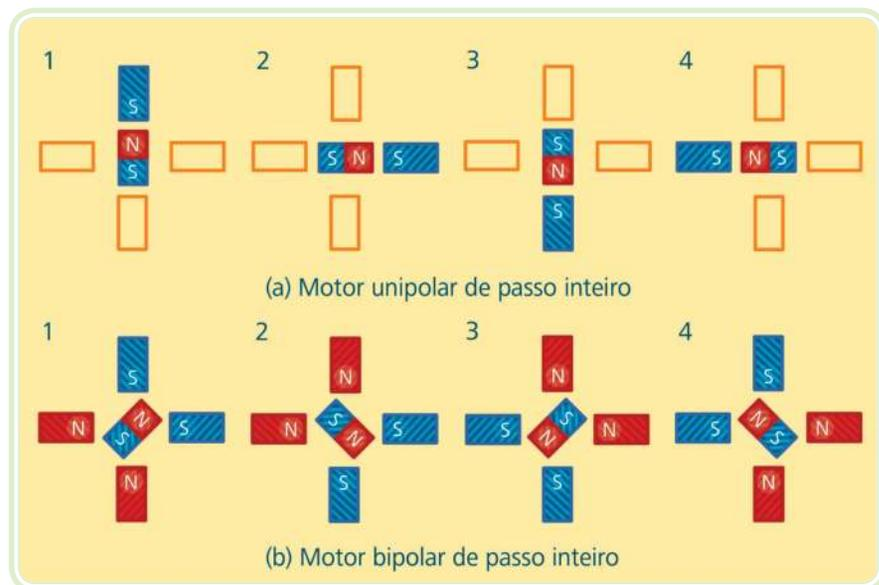
**Figura 3.12: Princípio de funcionamento do motor de passo: unipolar de passo inteiro (a) e bipolar de passo inteiro (b)**
