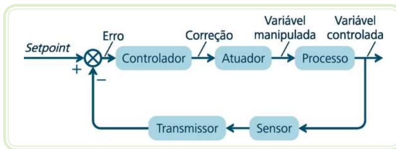
**Figura 3.20: Diagrama de blocos do sistema em malha fechada**
