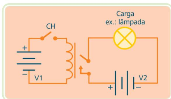
**Figura 3.2: Relé usado para acionar carga de baixa potência**
