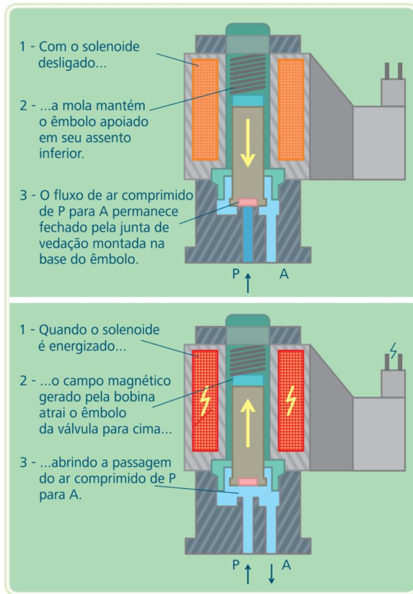
**Figura 3.17: Funcionamento da eletroválvula pneumática**
