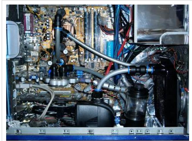
Circuito de refrigeración líquidaal interior de una computadora.
