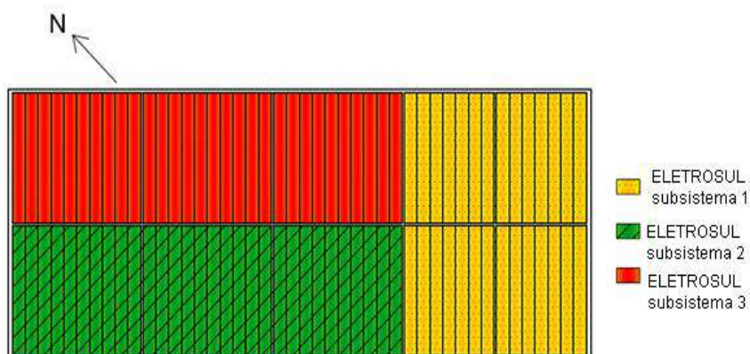
Figura 6.15 – Vista em planta da distribuição elétrica dos geradores fotovoltaicos da planta-piloto. Fonte: (ZOMER et al., 2012).
