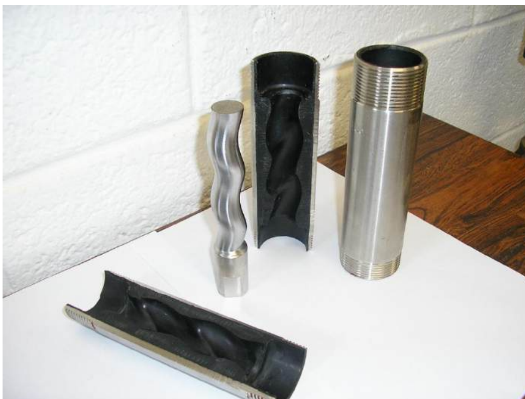
Figura 5.16 – Corte de uma bomba (somente o elemento bombeador) tipo parafuso, permitindo visualizar o rotor helicoidal e a forma construtiva interna de seu estator em material sintético (borracha); externamente, a bomba é o tubo em aço inox visto à direita. Fonte: (GALDINO, 2005).
