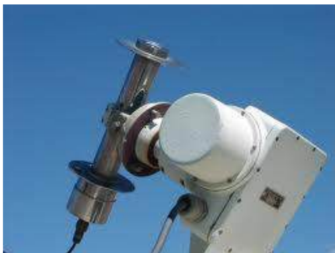
Figura 2.17 – Pireliômetro montado em um rastreador solar.
