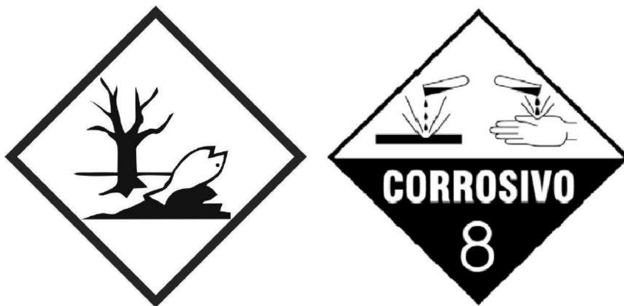
Figura 4.23 – Sinalização aplicável a baterias Chumbo-ácido.
