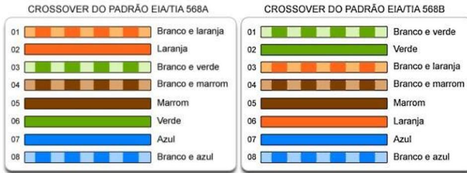
FIGURA 43 – Ligação de um Cabo Crossover
