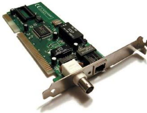
FIGURA 38 – Placa de Rede com Saída para Conector BNC
